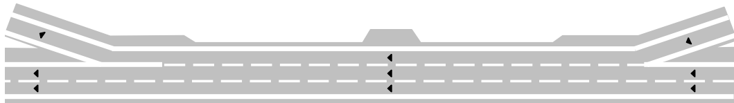
Abb. 2.1 PUN zwischen 2 benachbarten Anschlüssen.
